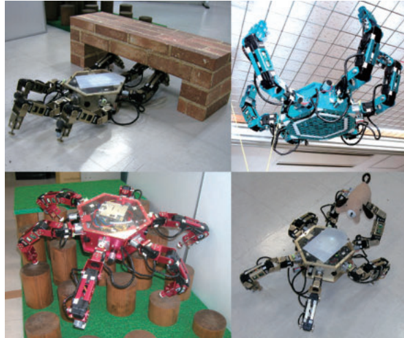
腕脚統合型ロボット「アスタリスク」 アスタリスクは、腕にも脚にも使える腕脚統合機能を持つ肢機構を大きな特徴としている。 この肢機構は、腕による作業と脚による移動を状況に応じて使い分けることで効率的な動作を可能にする。 愛・地球博へ出展し、格子状天井の歩行をはじめとした腕脚統合機能の特徴的な動作を紹介した。
