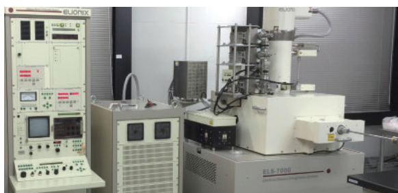
電子線描画システム 100kVに加速された電子線を用いて、微細パターンを描画します。
